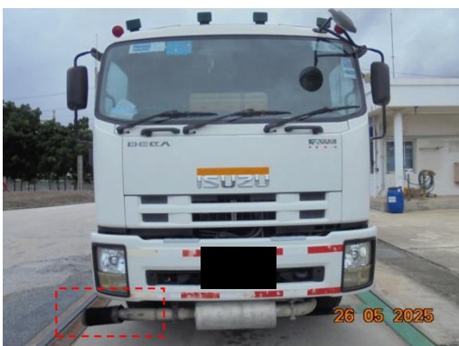
รูปที่ 3.2-54 อุปกรณ์ป้องกันประกายไฟที่ท่อไอเสีย
