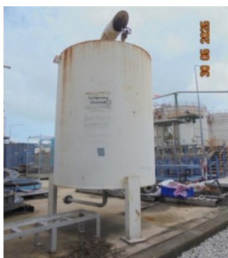
ปล่อง Charcoal Adsorber แบบเคลื่อนที่
